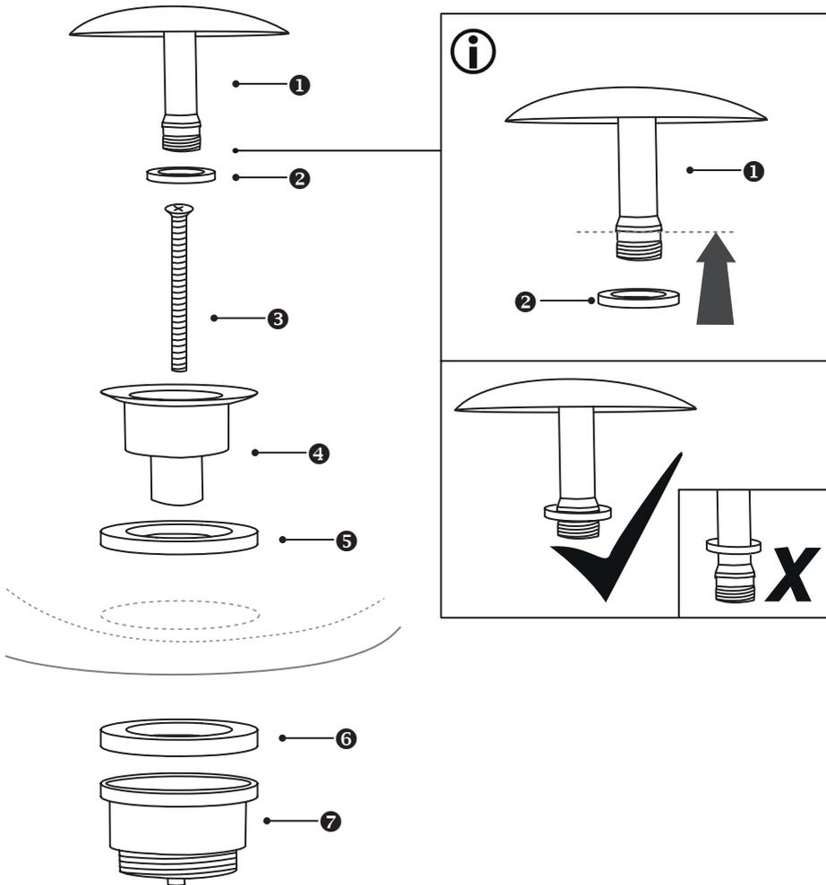
**Erklärung:** **1** Drückerplatte | **2** ½"-Dichtung | **3** Edelstahlschraube | **4** Oberteil | **5** Schaumdichtung
